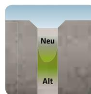
Die Fugen lassen sich leicht reparieren und instandsetzen - Schadstellen einfach mit STONES ECO FUGEN::SAND auffüllen und Einbauempfehlung befolgen. Es entsteht eine **kraftschlüssige Verbindung** zwischen altem und neuem Fugematerial.
