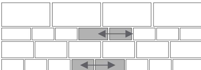
Durch den Tausch von zwei Steinen in jeder 2. Reihe wird die durchgehende Kreuzfuge unterbrochen. Die Fläche erhält so ihre Stabilität und die gewünschte Fugenoptik.
