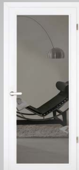
Modell Glatt | gefälzt mit smart 2 kante Verkehrsweiß ähnl. 9016 CPL Lichtausschnitt LA 110 Verglasung „Float grau“ | Zarge smart 2 kante 60 mm
